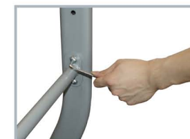
3.将横杆安装在立柱上部并固定。(如图所示)
