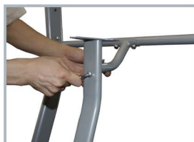
8. 用M8X25将立杆与连接管连上（XG-1915/5）
